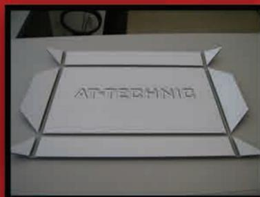
Découpe et rainurage de plaques Dibond par fraiseuses CNC
